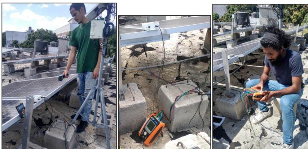
Figura 3. Trazado de curva IU antes y después de limpiar el panel con IU HT400
