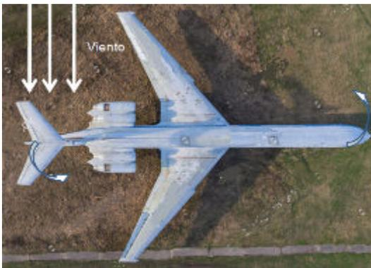
**Figura 6.** Fuerzas actuantes sobre el empenaje de la aeronave con viento cruzado
