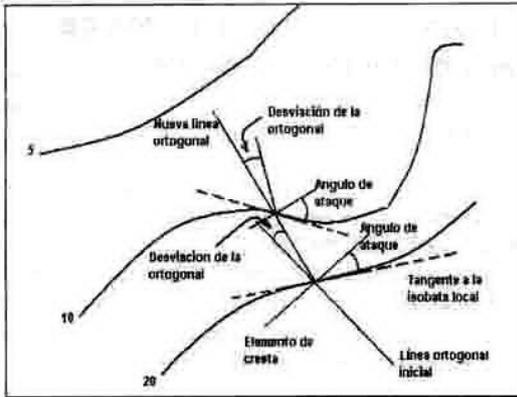
Fig. 4. Esquema de la determinación del cambio de dirección de la línea ortogonal en isobatas sucesivas.
