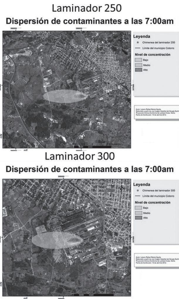
Fig. 2 Patrón de dispersión de los contaminantes emitidos por la chimenea del laminador 250 a las 7:00 a. m.
