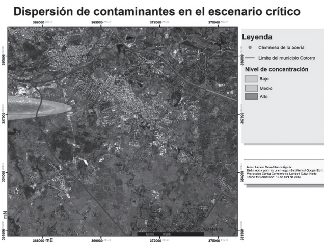
Fig. 7 Patrón de dispersión de los contaminantes emitidos por la chimenea de la acería en el escenario crítico.
