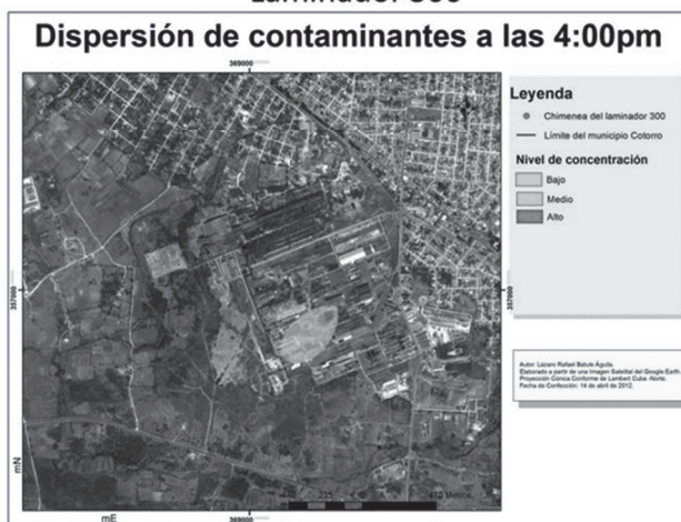
Fig. 4 Patrón de dispersión de los contaminantes emitidos por las chimeneas de los laminadores 250 y 300 a las 4:00 p.m.
