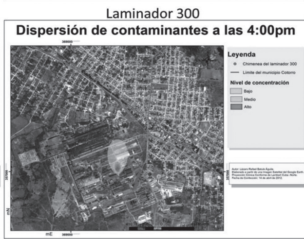
Fig. 6 Patrón de dispersión de los contaminantes emitidos por las chimeneas de los laminadores 250 y 300 a las 4:00 p. m., con viento de dirección sur.
