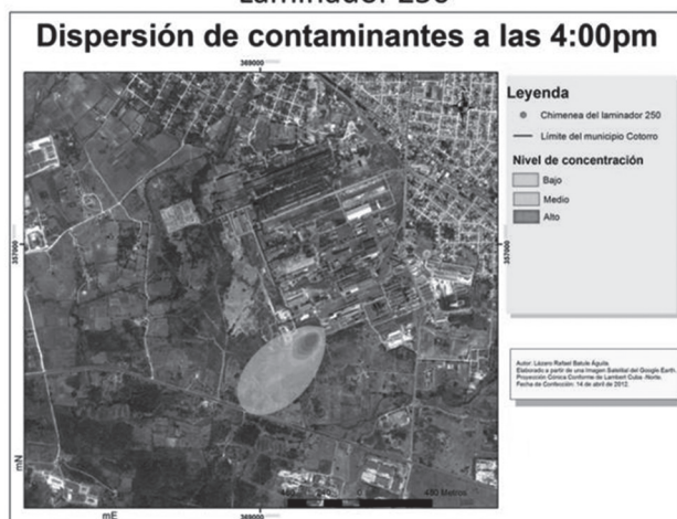
Fig. 3 Patrón de dispersión de los contaminantes emitidos por la chimenea de la acería a las 4:00 p.m.
