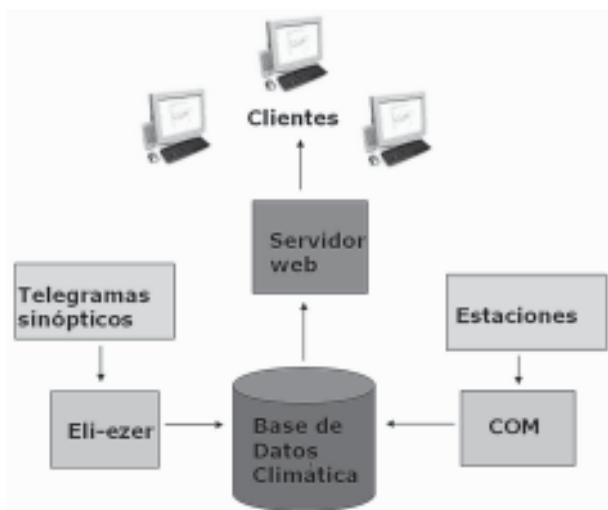
Fig. 2. Esquema general donde se muestra cómo entran los datos de las estaciones de superficie al sistema.
